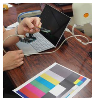
図 13 カプセル用超小型カメラを用いたテストパターン撮影
