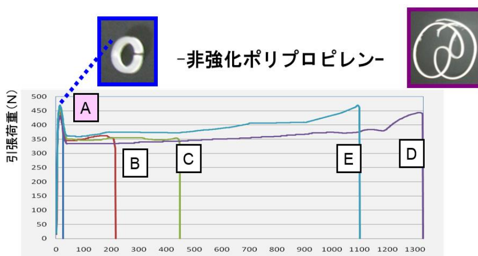
図 2 2 C O P 成形品の物性向上例 (B ~ E が樹脂流動制御)
