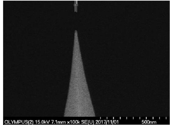
図18 三角錐形状のカンチレバー探針の高倍率 SEM 画像
