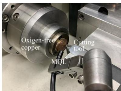
図 27 無酸素銅の加工実験に使った非球面レンズ加工機の外観
