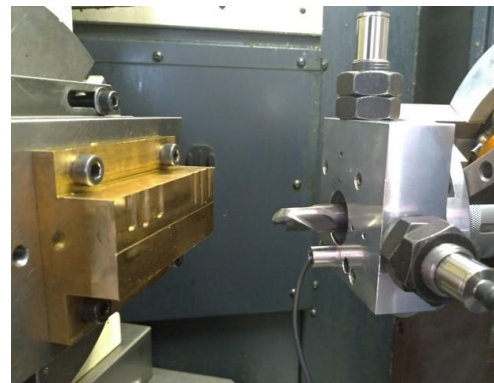
図11 変位測定実験のセットアップ
