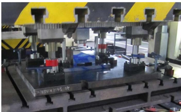
図7 熱可塑性複合材料のトリム成型に用いた金型
