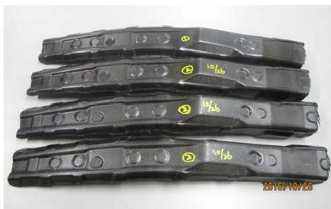
図3 熱可塑性CFRP材のプレス成型結果
