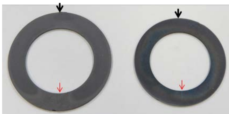
図2 成形体および焼結体 (ゲート位置およびウェルドラインに矢印を付した)
