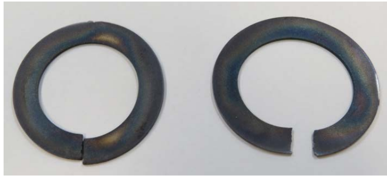
図3 焼結体不良品の例，ウエルド部での破損，変形
