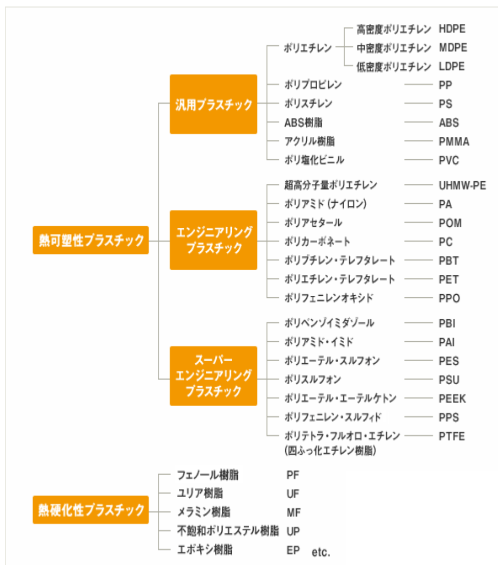
図3 熱可塑性樹脂と熱硬化性樹脂の分類
