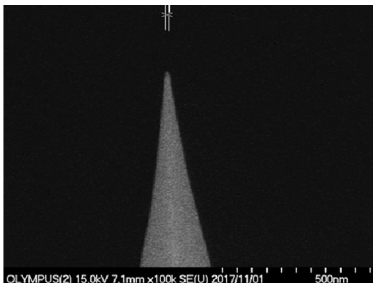
図10 カンチレバー先端の高倍率顕微鏡写真 (オリンパスからの写真提供 (OMCL-AC160TS), 先端球の半径 r_p : 平均7 nm, 最小4 nm, 最大10 nm)
