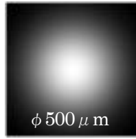
(a) 一般的なレーザービーム径 (約 500 \mu\text{m} )
